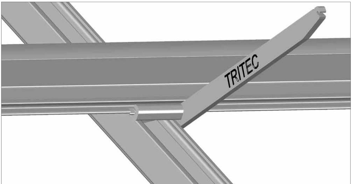
5. Die Abkantungen müssen entsprechend dem Bild ausgeführt sein. Immer nur an einem mittigen SAFE-CLICK je TS-Profil!
